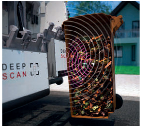
Störstofferkennung im Biomüll, Quelle: ZOELLER
