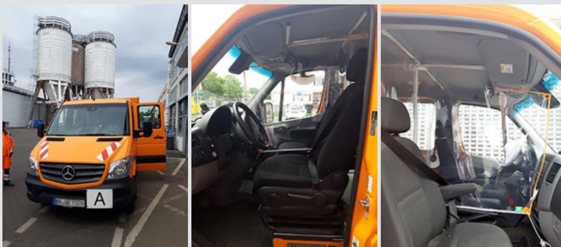
Abtrennungen im Fahrerhaus zum Mitarbeiterschutz, Quelle: bonnorange
