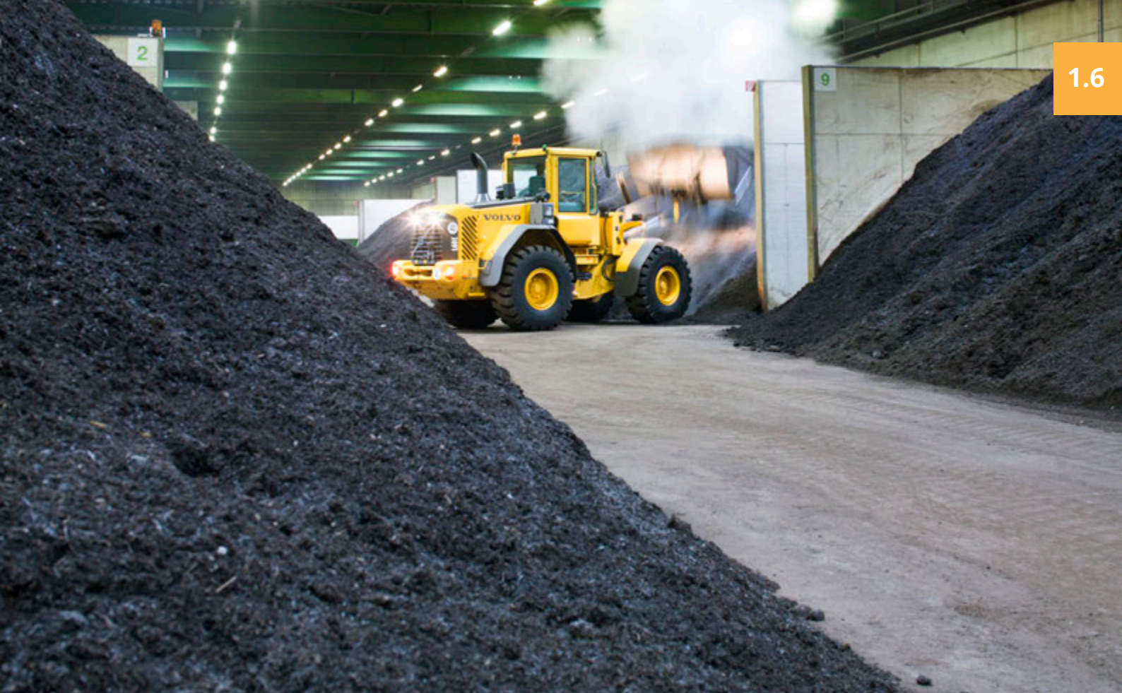
Entladung der Rottekammern im Kompostwerk, Quelle: AVG Köln
