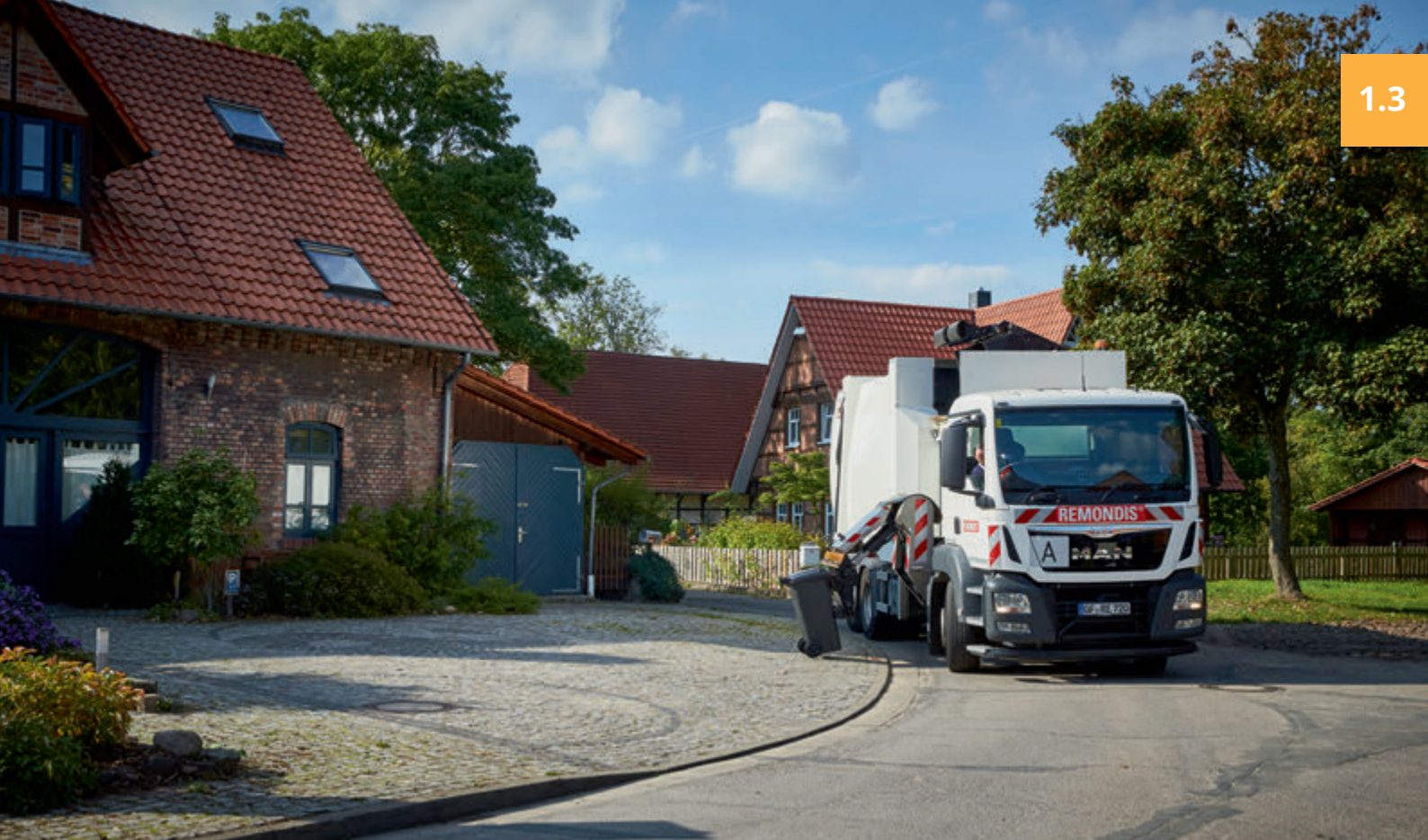
Restmüllsammung mit Seitenlader im ländlichen Raum, Quelle: REMONDIS
