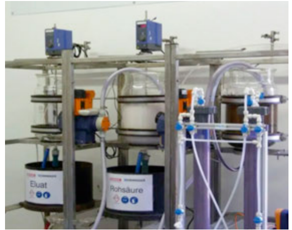
Phosphorrückgewinnung aus Klärschlamm, Technikumsanlage der Eurawasser Nord GmbH in Rostock. Quelle: Remondis
