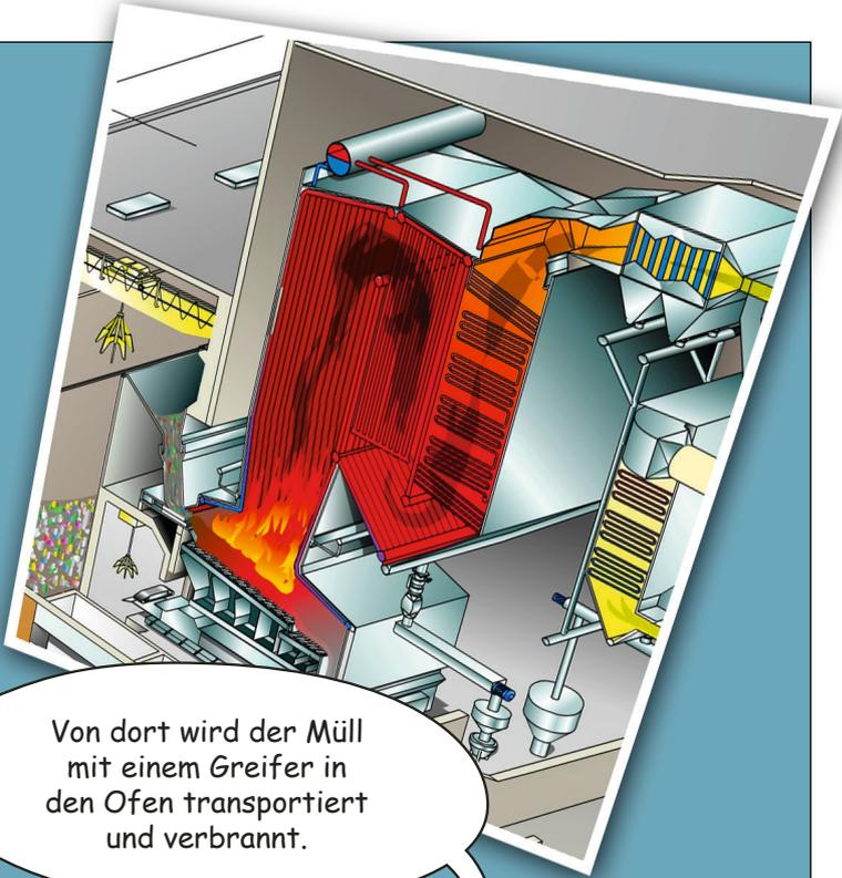
Von dort wird der Müll mit einem Greifer in den Ofen transportiert und verbrannt.
