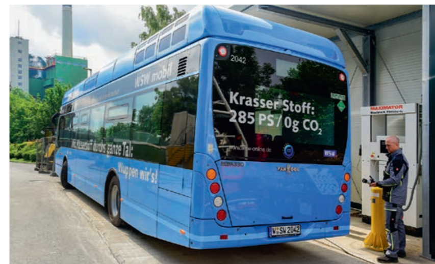
Energie aus Abfall: Auf dem Gelände der AWG Wuppertal werden die Brennstoffbusse mit Wasserstoff betankt und sind dann nahezu emissionsfrei unterwegs (l.). In Schwandorf versorgt der Zweckverband ZMS den Industriebetrieb Nabaltec mit Energie (u.).
