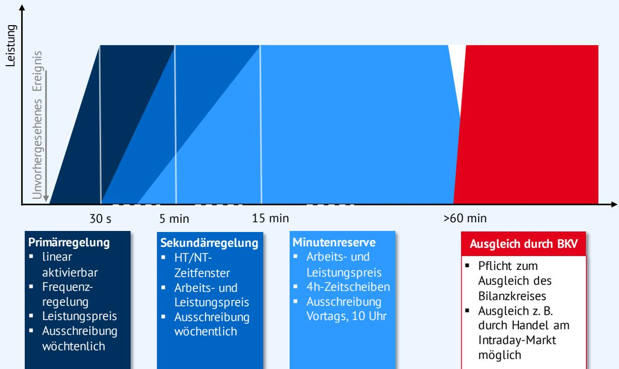
Abbildung 15: Schematische Darstellung der Regelleistungsarten
